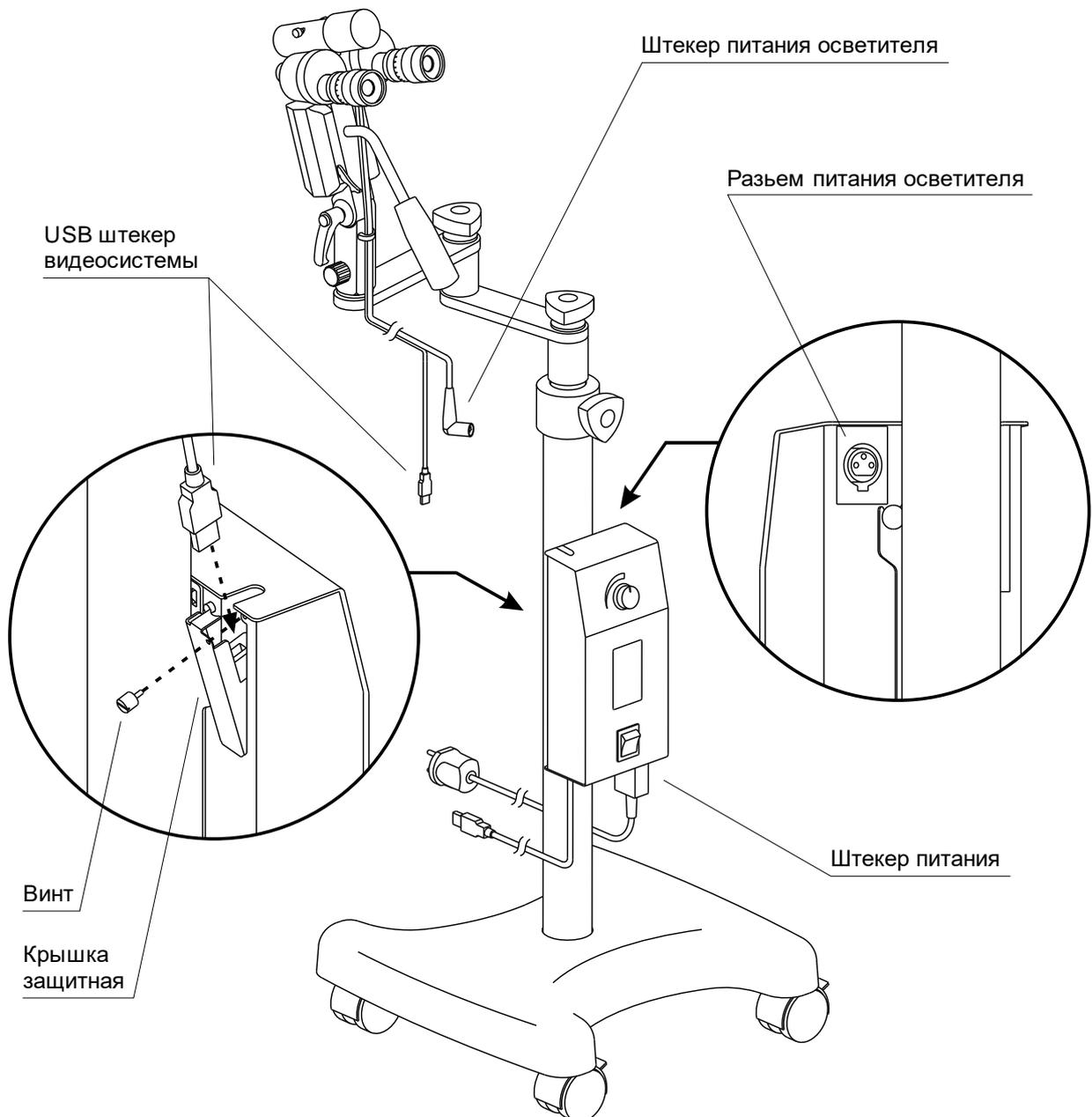
5. Подключите штекер питания кольпоскопа в сетевой разъем снизу блока питания.
